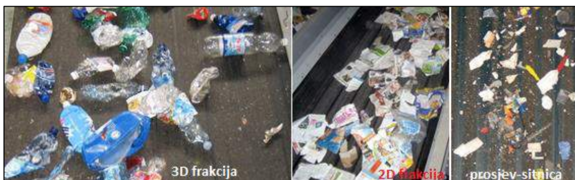
Slika 1 Tri toka GIO frakcije razdvojene balističkim separatorom
